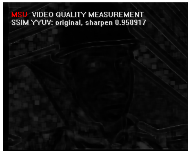
(d) SSIM map for sharpen image, SSIM = 0.958917
