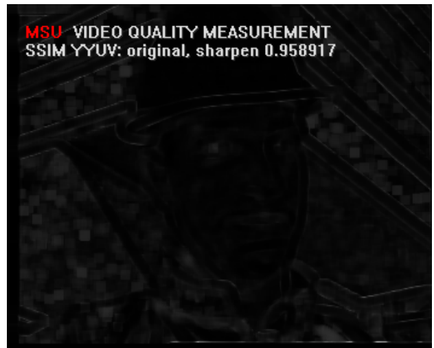
(d) SSIM map for sharpen image, SSIM = 0.958917
